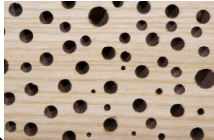
Die Löcher sind sauber gebohrt. Der Abstand könnte teilweise etwas größer sein.
